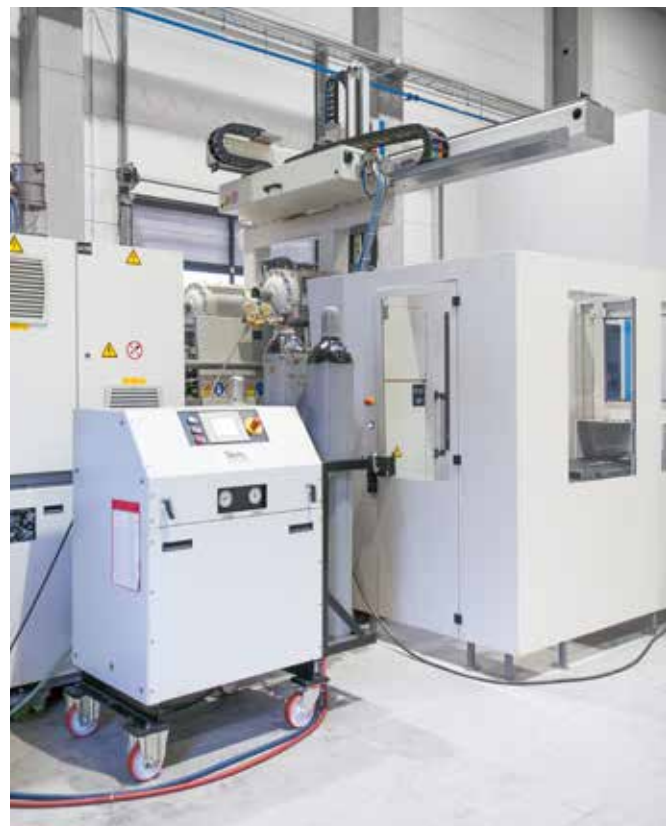
Die Mucell-Einheit auf der Rückseite der Maschine.
