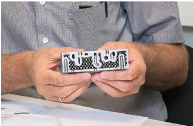
Der Schnitt durch einen generativ erzeugten Werkzeugeinsatz zeigt die konturnahе Temperierung und den reduzierten Rückraum.
